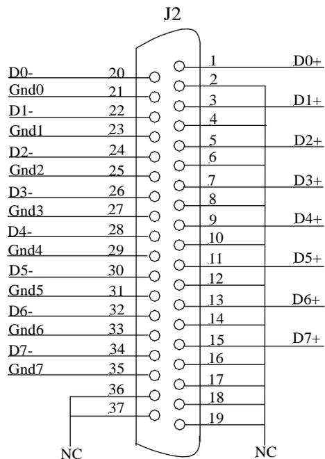
Figure 5. DB37 input connector J2
